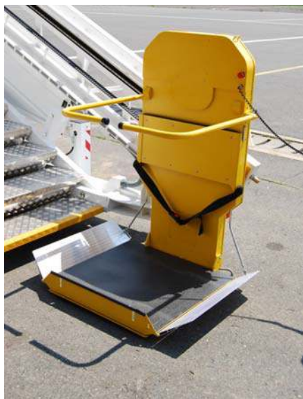
Рисунок 6 и 7: Подъемная платформа с ограждающими поручнями и пандусами в режиме движения.
