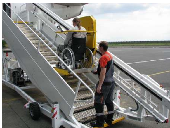
Рисунок 4 и 5: Сопровождающий может контролировать платформу с помощью пульта, подключенного к платформе растягивающимся спиральным кабелем, идя впереди или позади платформы.
