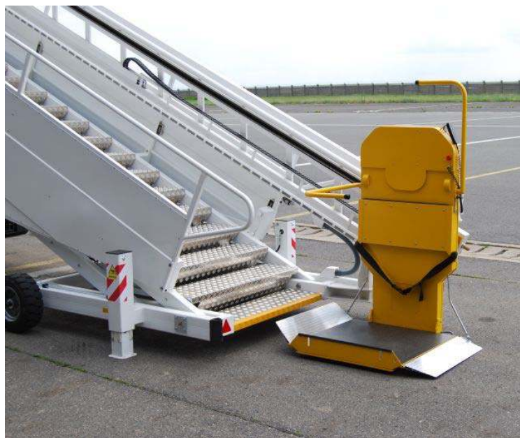
Рисунок 1: Платформа Икарос со сложенным сиденьем на платформе. Пандус и ограждающий поручень можно видеть в открытом положении на фотографии выше.
