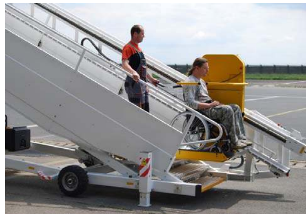
Рисунок 4 и 5: Сопровождающий может контролировать платформу с помощью пульта, подключенного к платформе растягивающимся спиральным кабелем, идя впереди или позади платформы.
