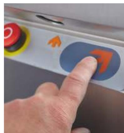
После использования, подъемник складывается нажатием кнопки на пульте управления. Лестница снова доступна и свободна от препятствий.
