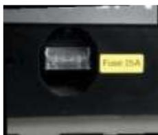
Предохранитель с внешним доступом. Теперь не надо снимать кожух для его замены.
