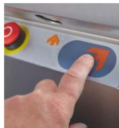
После использования, подъемник складывается нажатием кнопки на пульте управления. Лестница снова доступна и свободна для использования в обычном режиме.
