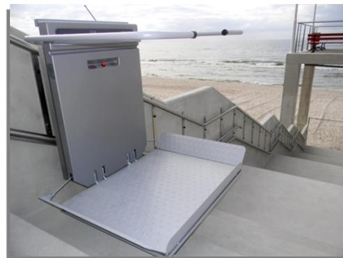
Стандартная комплектация: Исполнение УХЛ 4.2 (для использования внутри помещения), платформа 800x1250 мм, проходная. Цвет исполнения серый RAL 9006, питание: до 0,50 кВт, 220 В, 1 Ф, управление: кнопочно-клавишное, аварийная кнопка на платформе.
